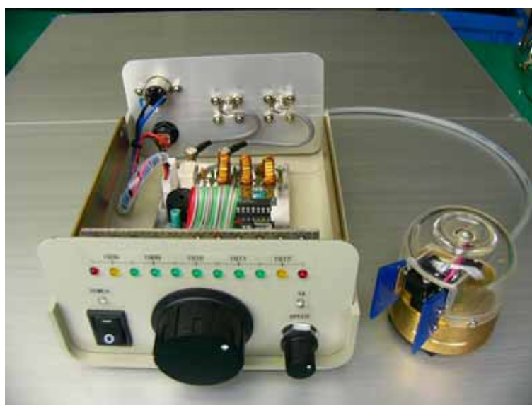
終段 AT90S1200 ワンチップCW送信機 と 自作パドル
